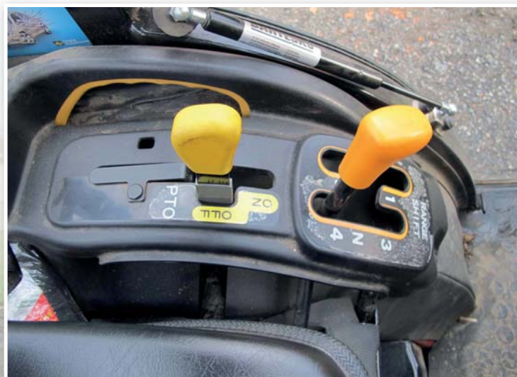
Pod řadič pákou je spínač vývodového hřídele
