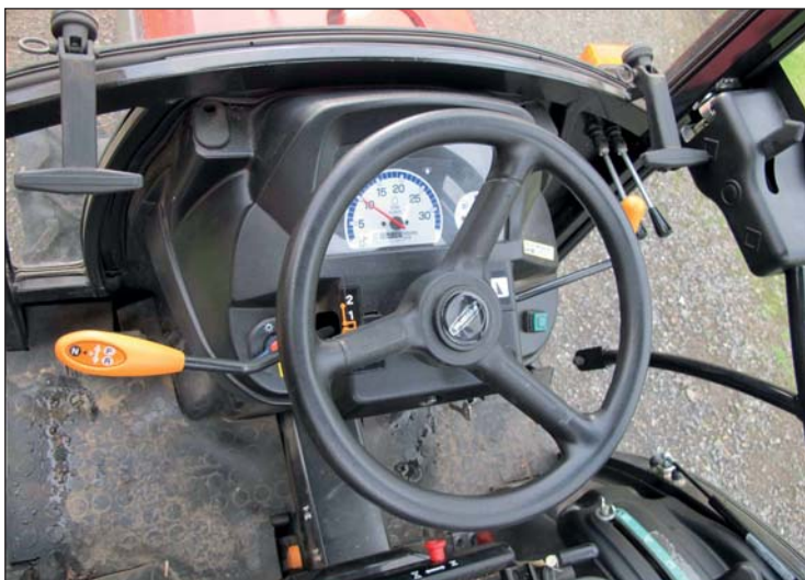
Vlevo od volantu se nalézá řadič směru jízdy, od plavivé rychlosti až po 13 km/h
