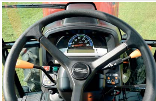
Vlevo pod volantem je páka power shuttle se řazením pojezdu vpřed či vzad, vpravo ruční plyn
