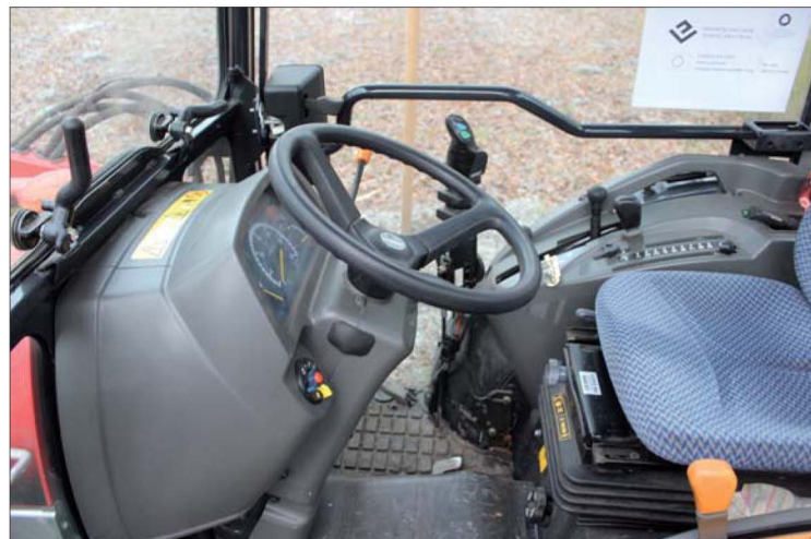
Ovládací páky spojené s řazením jsou umístěny na levé straně a páky řídící hydraulický systém traktoru jsou na pravé straně kabiny
