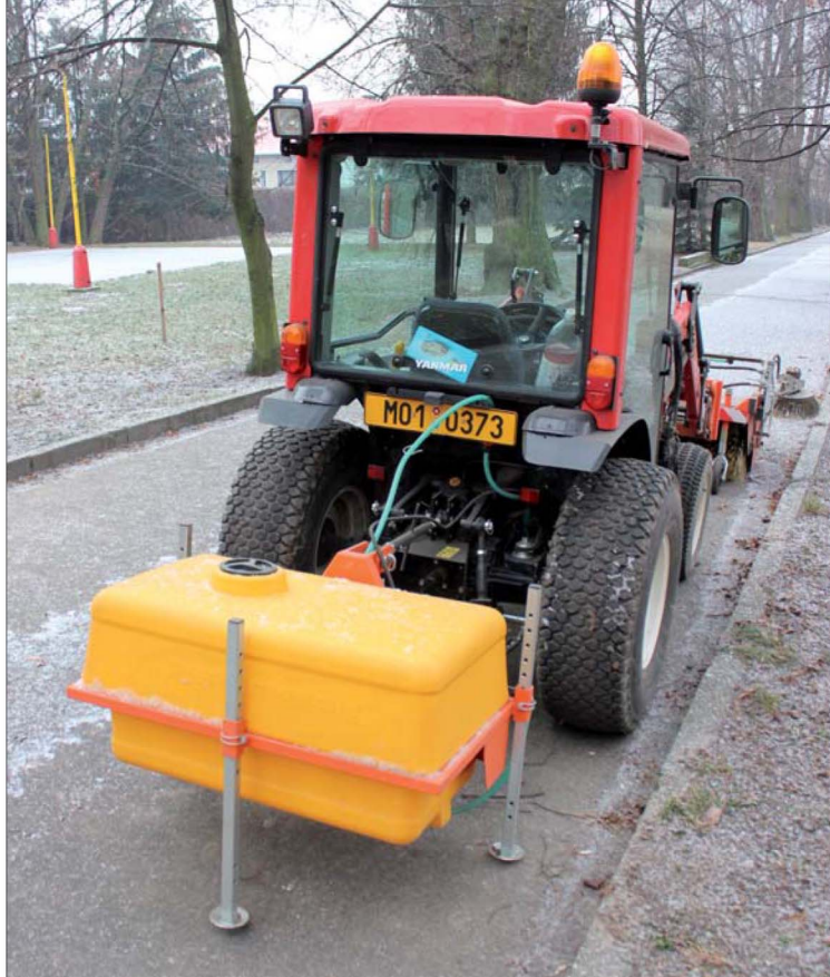
Nedílnou součástí zametacího zařízení je systém skrápění s nádrží s kapacitou 200 litrů
