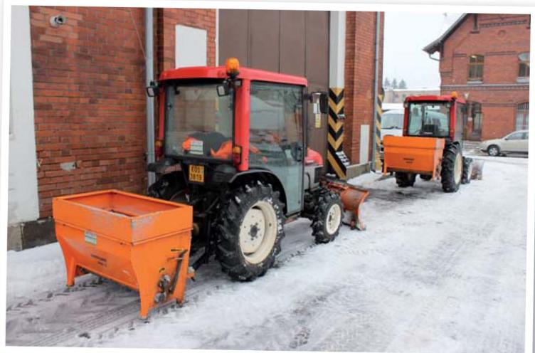
Při zimní údržbě chodníků jsou traktory vybaveny čelními sněhovými radlicemi a válečkovými sypači Vestas Hydromann SNOWLINE 200 G
