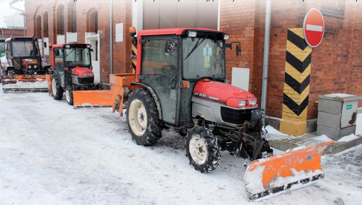
V Ašských službách pracují dva traktory Yanmar EF 235 s hydrostatickým pojezdem
